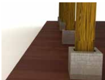
Рис. 6.2. Жесткое соединение стойки веранды с фундаментом
